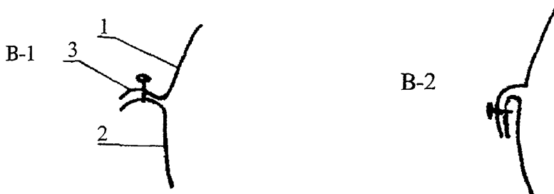
В-1 края отогнуть для монтажа
