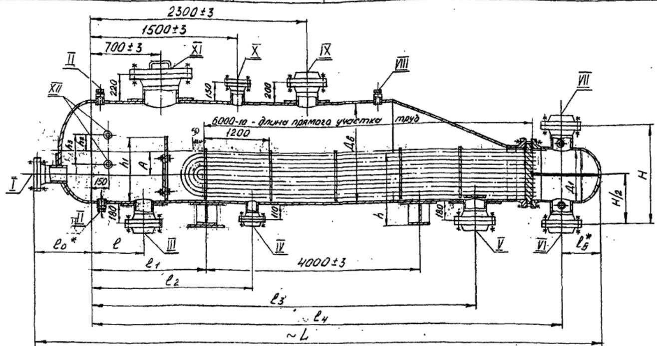
I - Ду 200мм - для монтажа пучка; II - Ду 40мм - для регулятора уровня; III - Ду 4 - выход остатка продукта;
