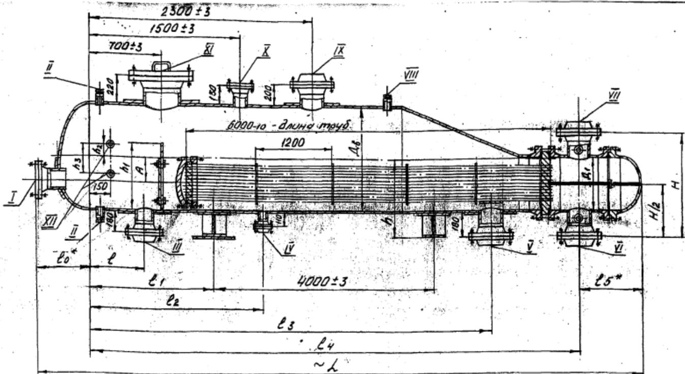
I - Дч 200мм - для монтажа пучка; II - Дч 40мм - для регулятора уровня; III - Дч<sub>4</sub> - выход остатка продукта;
