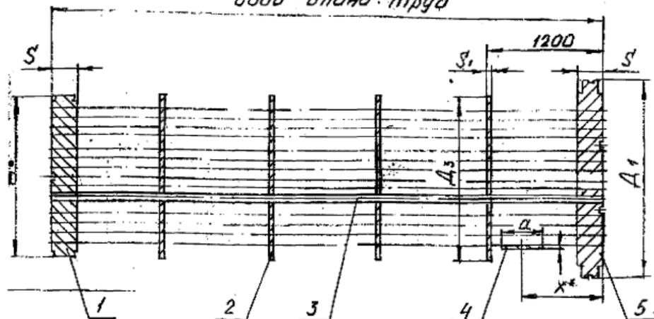
1-решетки подвижная; 2-перегородки; 3-трубы теплообменная; 4-отбойник; 5-решетки неподвижная.
