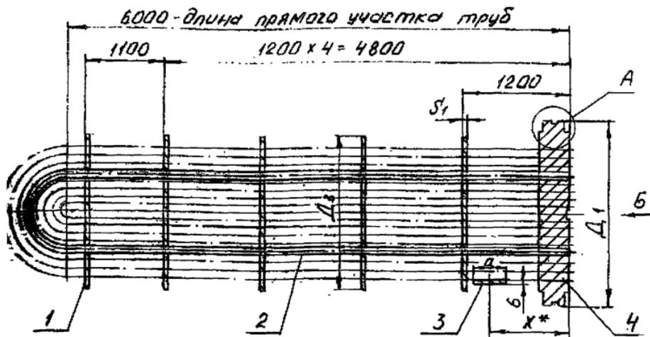
1-перегородка; 2-трубы теплообменная;
