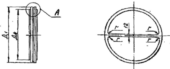
Решетки неподвижные для трубных пучков аппаратов типа ИП при четырех ходах по трубам.
