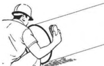
Рисунок Б.1 – Очистка поверхности трубы
