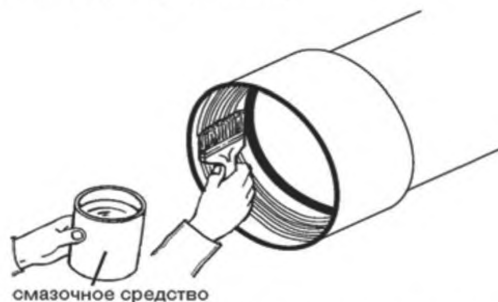
Рисунок Б.3 – Нанесение смазочного средства
