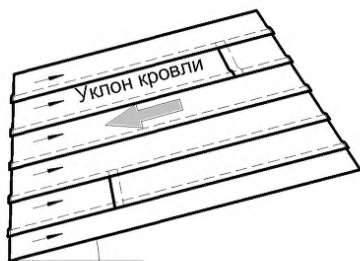
Рисунок 6.2 – Укладка материала на скате крыши вдоль уклона
