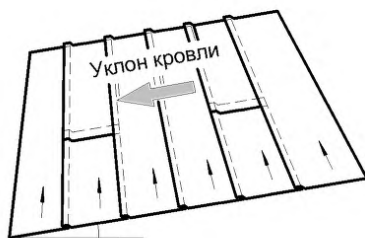
Рисунок 6.3 – Укладка материала на скате крыши поперек уклона
