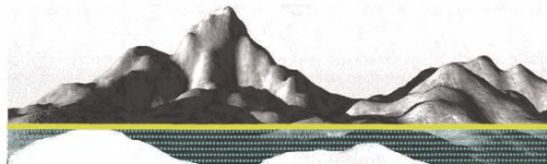
Рисунок 8.17 – Базовая плоскость находится выше поверхности
