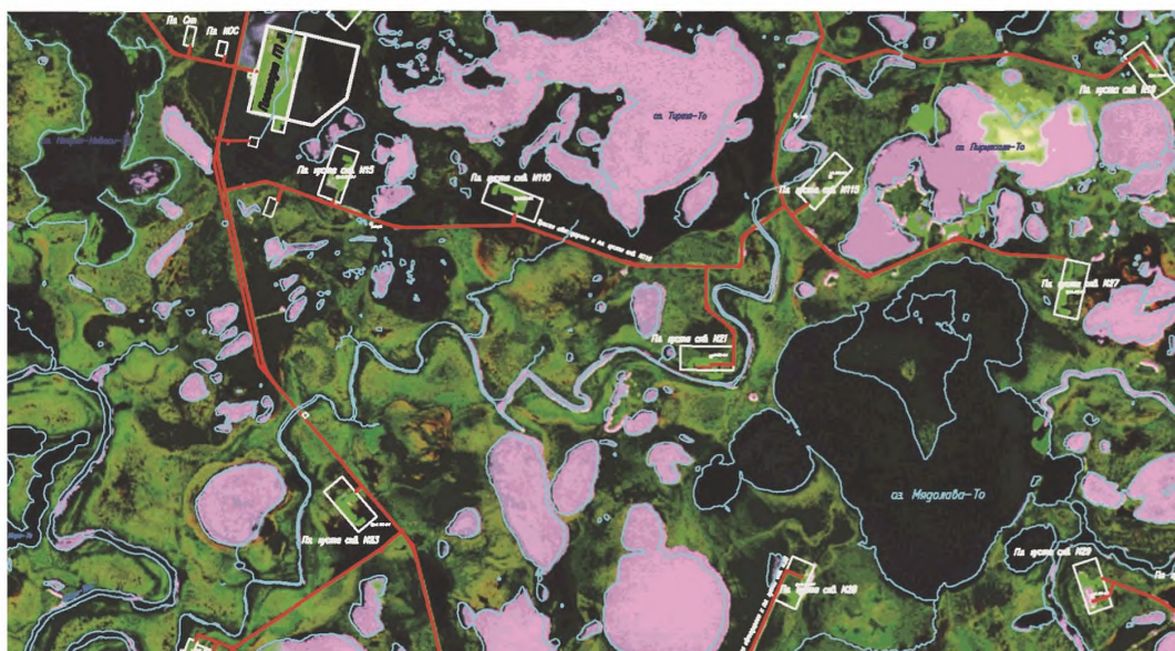
Рисунок 8.25 – Результат вставки снимка с геопривязкой (Landsat-8 от 07.06.2015) в план местности.
