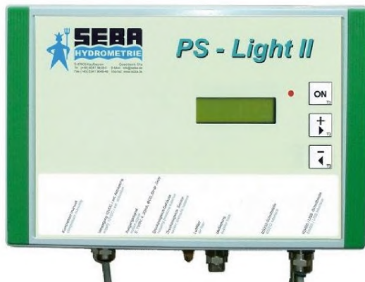
Рисунок 10 – Внешний вид барботажного уровнемера «PS-Light-2»
