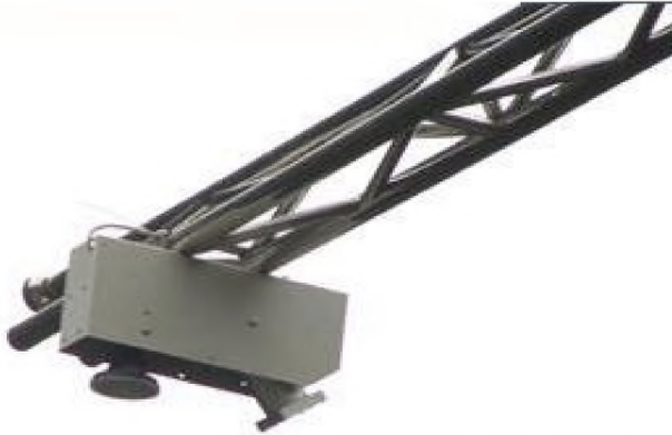
Рисунок 17 – Установка системы измерения на конструкциях моста
