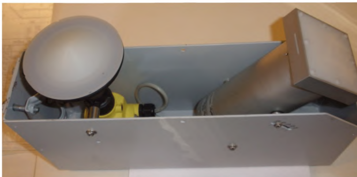
Рисунок 16 – Внешний вид системы измерения - радиолокационного измерителя скорости воды и уровня
