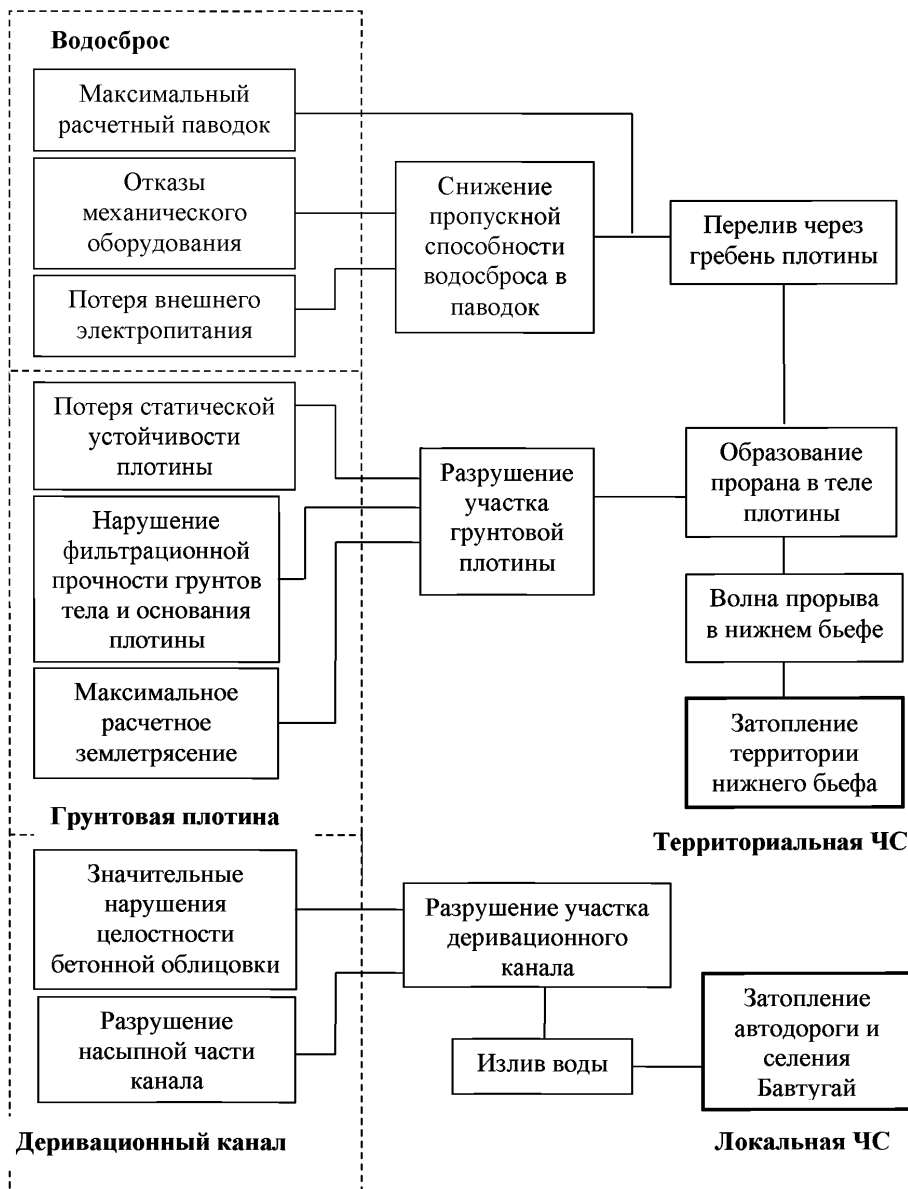
Рисунок Б.1 - Блок-схема анализа основных вероятных сценариев возникновения и развития аварий на ГТС Чирчюкских ГЭС.
