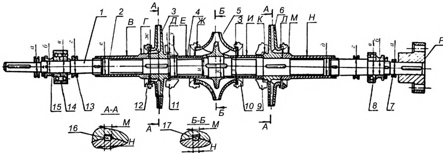
Рисунок 4 – Ротор насосов Кс125–140 и КсД230–115
