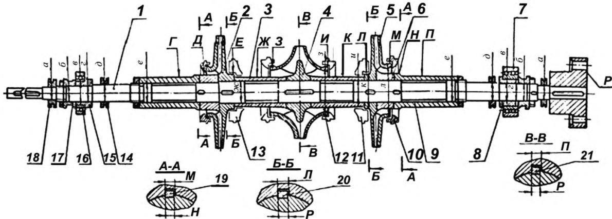
Рисунок 3 – Ротор насоса Кс125-55
