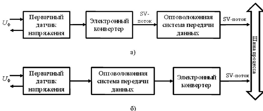
Рисунок 7.2. Обобщенная структурно-функциональная схема однофазного ЭТН
