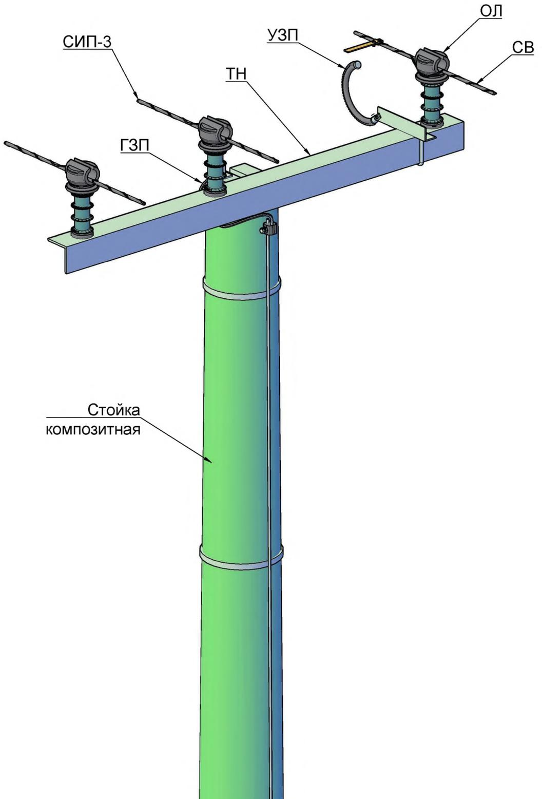
**Спецификация к "4.1.1.Промежуточные одноцепные композитные опоры ВЛЗ 6-20кВ,
