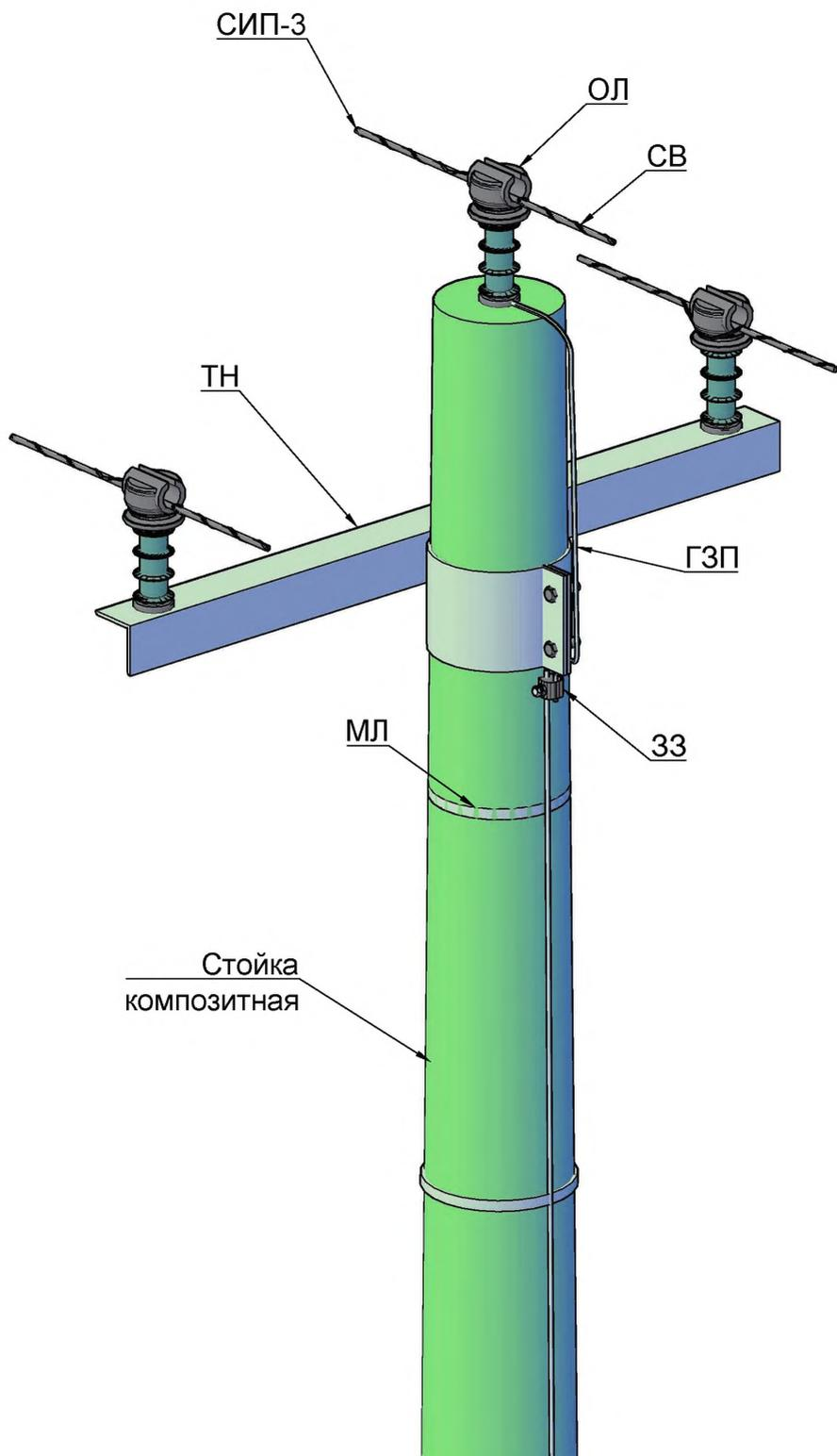
**Спецификация к "4.1.2.Промежуточные одноцепные композитные опоры ВЛЗ 6-20кВ,
