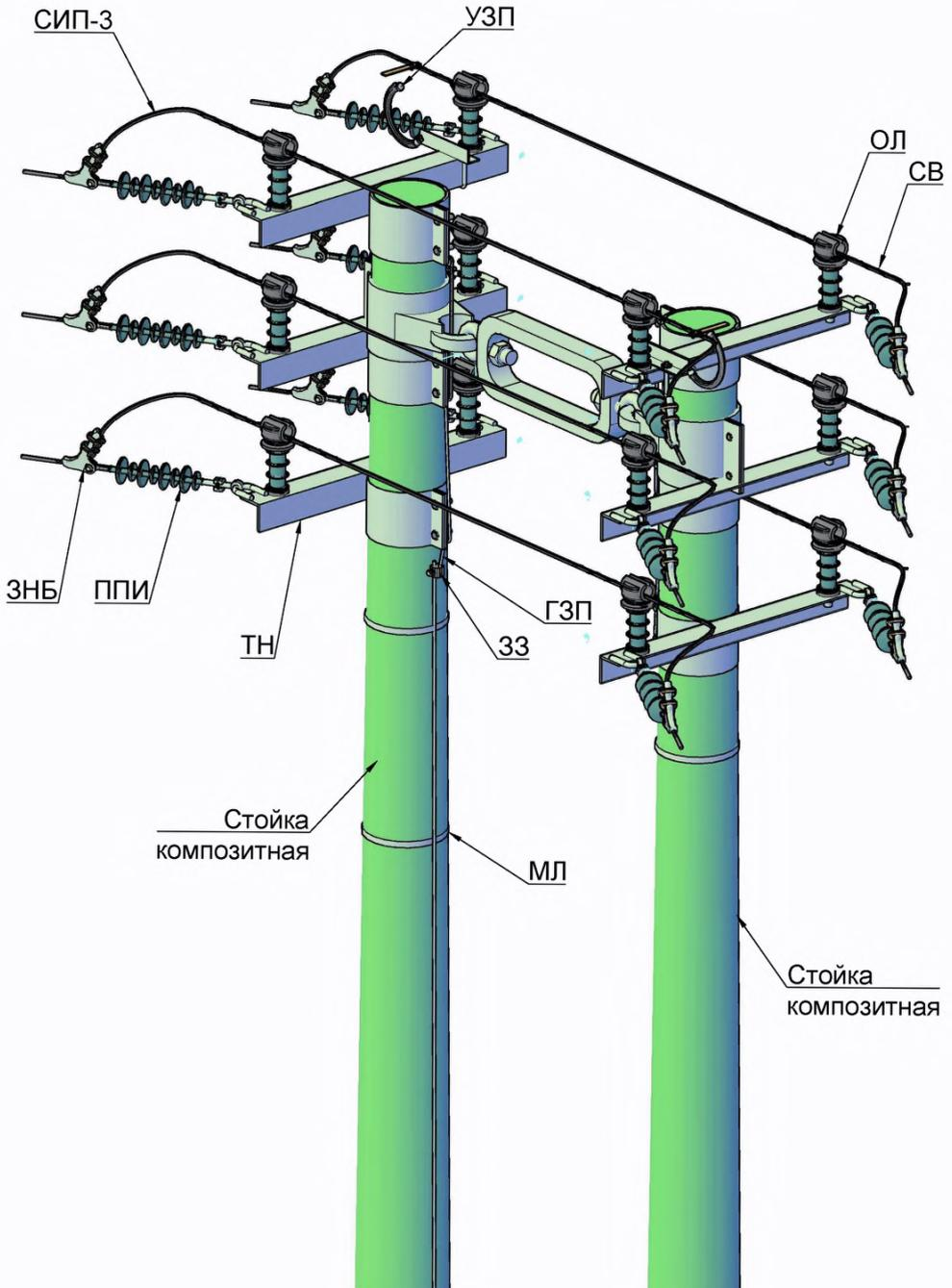
**Спецификация к "5.3.1.Угловые анкерные двухцепные композитные опоры
