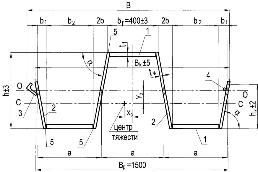
Рисунок 8.1 — Панель рядовая ПШС  $B_p = 1500$  мм
