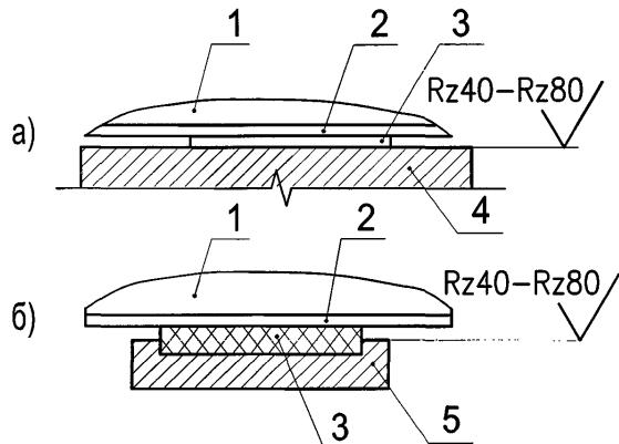
Рисунок 28.3 — Расположение в устройствах антифрикционных прокладок.
