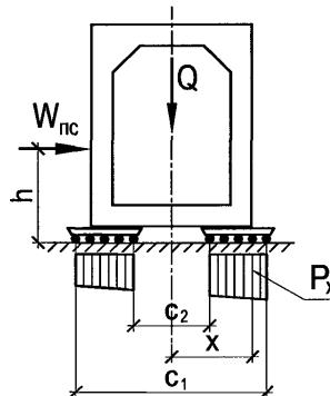
Рисунок 27.2 – Расчетная схема давления на накаточный путь.
