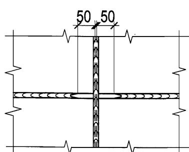
Рис. 11.3 – Пересечение стыковых швов
