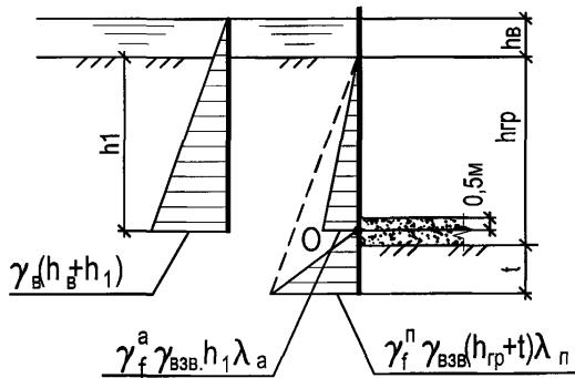
Рисунок 17.4 – Схема, используемая в расчетах шпунтовых ограждений, не имеющих распорных креплений
