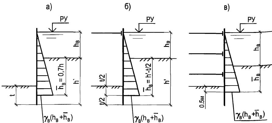
Рисунок 17.2 — Схемы для определения глубины проникания воды между шпунтовой стенкой и водонепроницаемым грунтом
