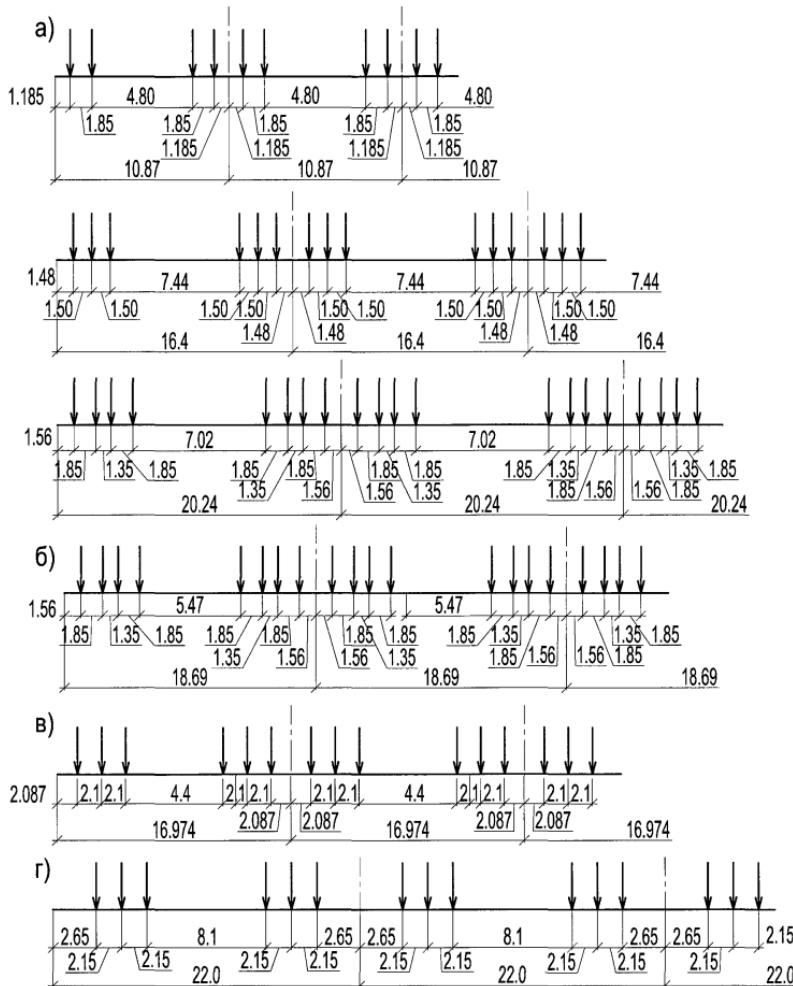
Схемы осевых нагрузок подвижного состава:
