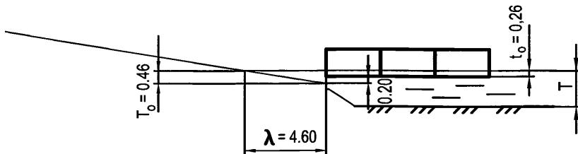
2 Схема спуска плашкоута  $H=3,6$  м
