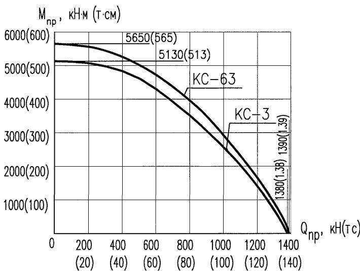
Рисунок 7.2 — График предельных усилий на ponton при изгибе
