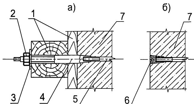
Рисунок 38.1— Тяжи со съемными наконечниками
