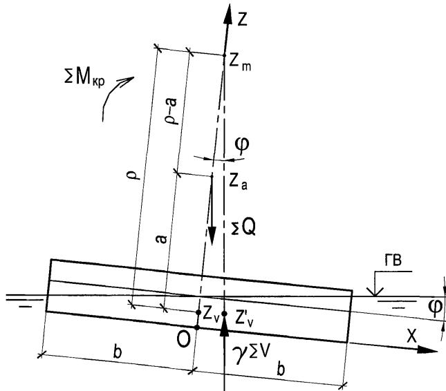
Рисунок 32.1 — Схема определения остойчивости плавучей опоры.
