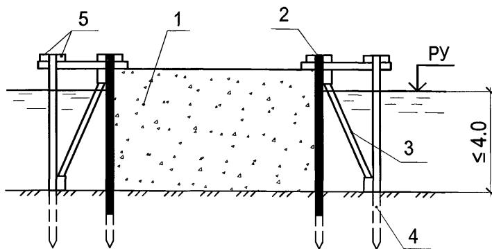
Рисунок 19.2 — Островок в деревянном шпунтовом ограждении
