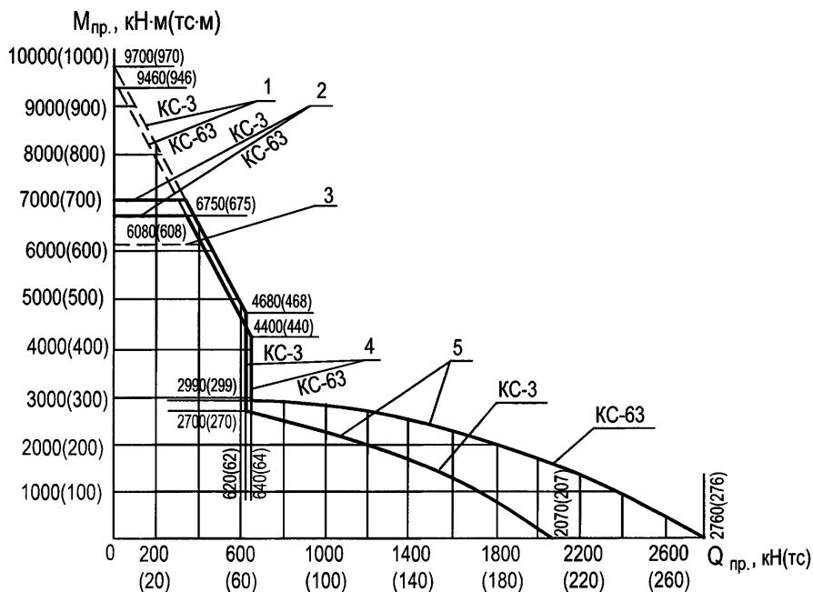
Рисунок 7.3 — График предельных усилий на понтоны КС-3 и КС-63
