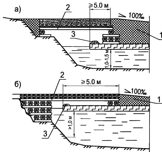
Рисунок 36.1 — Сопряжение ледовой дороги с берегом
