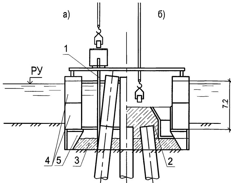
Рисунок 21.1 – Бездонный ящик из понтонов КС
