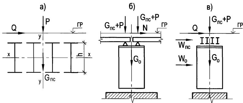
Рисунок 12.1 — Схемы приложения нагрузок в подкрановых эстакадах
