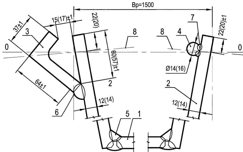
Рисунок 8.2 — Замковые элементы для панелей шириной
