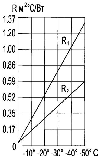
Рисунок 38.4 — Кривые зависимости оптимального термического сопротивления боковых поверхностей опоры  $R$ (в  $\text{м}^2 \text{°C}/\text{Вт}$ ) от расчетной температуры наружного воздуха,  $^{\circ}\text{C}$  ( $R_1$  - для торцовых поверхностей и боковых частей поверхности, прилегающих на 2 м к углам опоры;  $R_2$  - для остальных частей боковых поверхностей).
