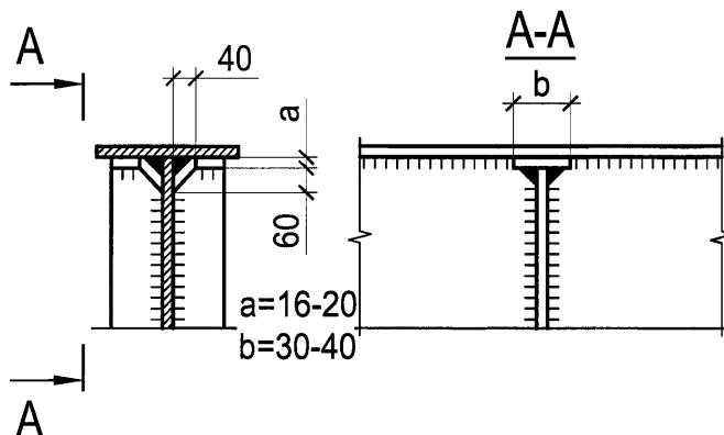
Рис. 11.1 – Примыкание ребер жесткости к поясам балки.
