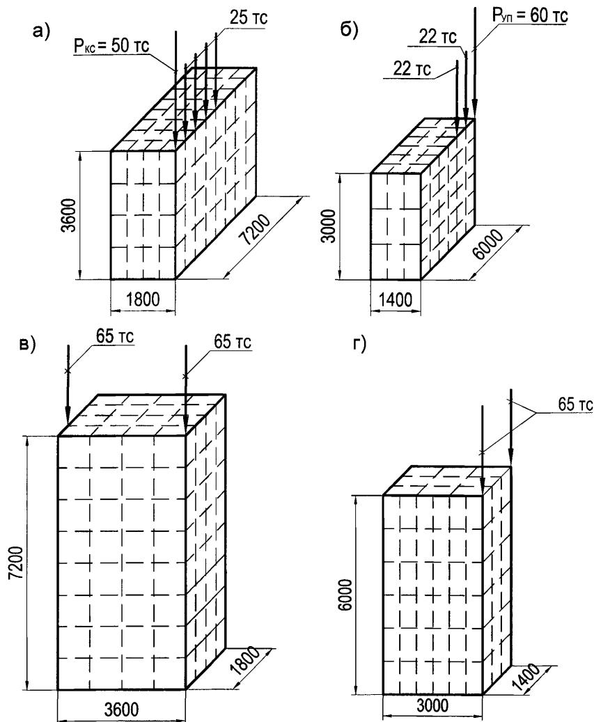
Рисунок 7.8 — Схема предельных нагрузок на понтон
