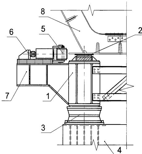
Рисунок 28.4 — Направляющее устройство
