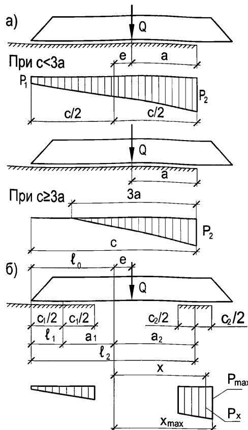
Рисунок 26.2 – Расчетные схемы нижнего накаточного пути
