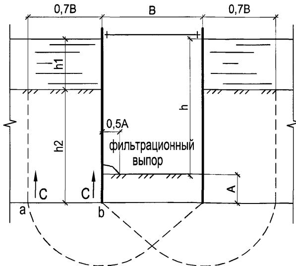
Рисунок 17.1 — Расчетная схема к проверке дна котлована
