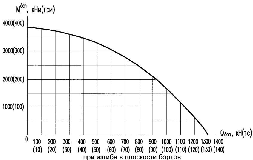
Рисунок 7.5 — График допустимых усилий на pontон УП-78
