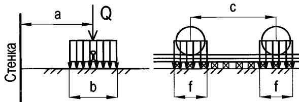
Рисунок 10.3 — К определению эквивалентной нагрузки от однорельсовой тележки на призме обрушения.
