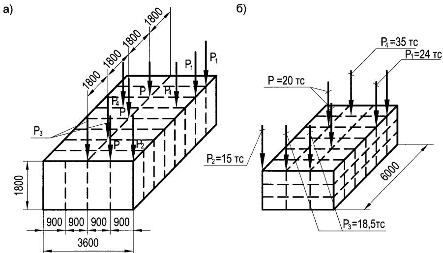
Рисунок 7.1 — Схема нагрузок на узлы pontонов
