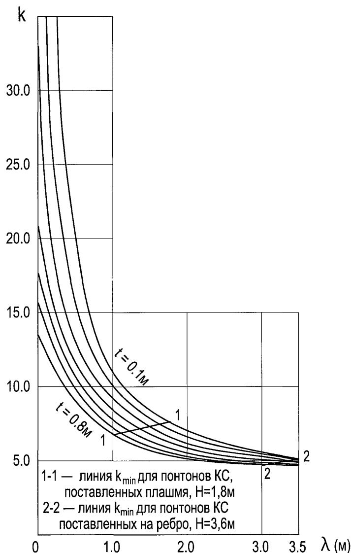
Рисунок 1 — График коэффициента влияния разобщения воздухопровода для понтонов  $H = 1,8$  м и  $H = 3,6$  м
