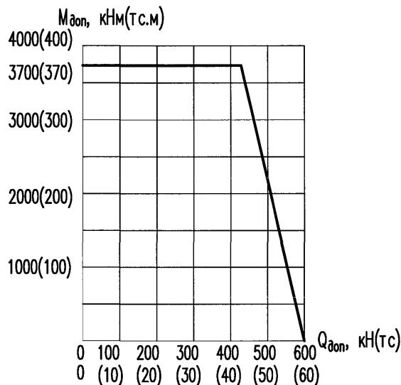
Рисунок 7.4 — График допустимых усилий на pontон УП-78
