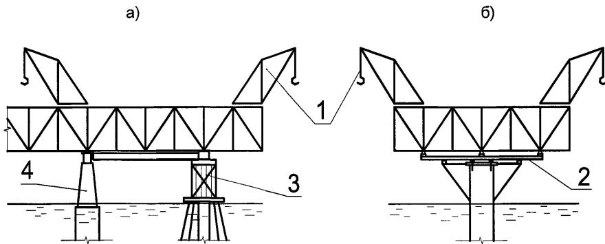
Рисунок 25.1 – Опорные устройства для уравновешенной сборки
