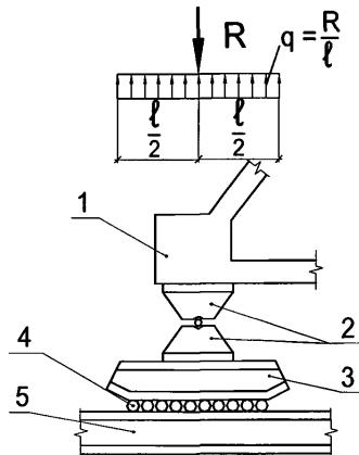
Рисунок 28.5 — Балансирное опирание узла пролетного строения
