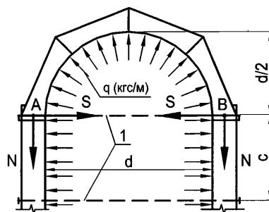
Рисунок 38.2 — Расчетная схема кружальных ребер опалубки опоры
