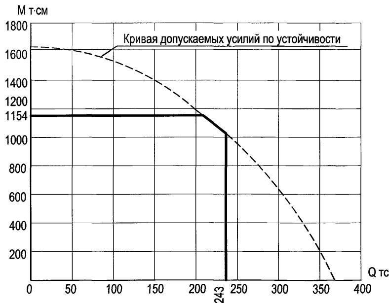
Рисунок 7.7 — График допускаемых усилий на понтон КС-63М
