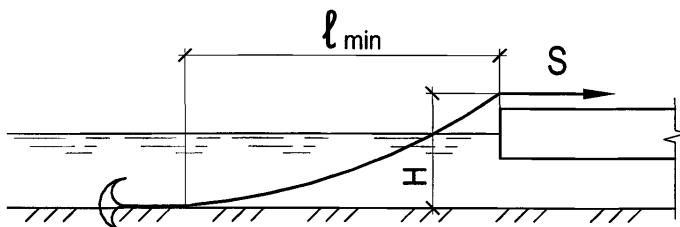
Рисунок 32.2 — Схема определения длины якорного каната.
