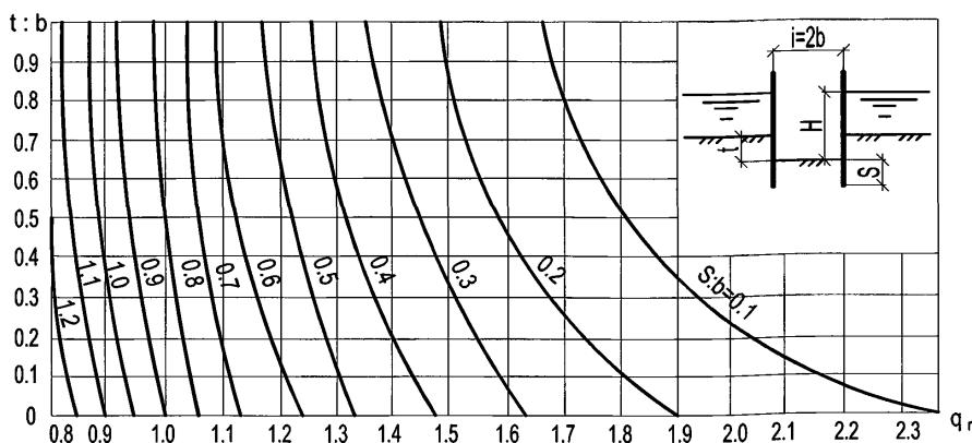
Рисунок 1 — График для определения  $q_r = f(S : b; t : b)$
