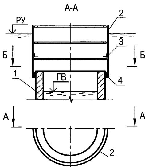
Рисунок 21.4 – Стальное ограждение верхней части
