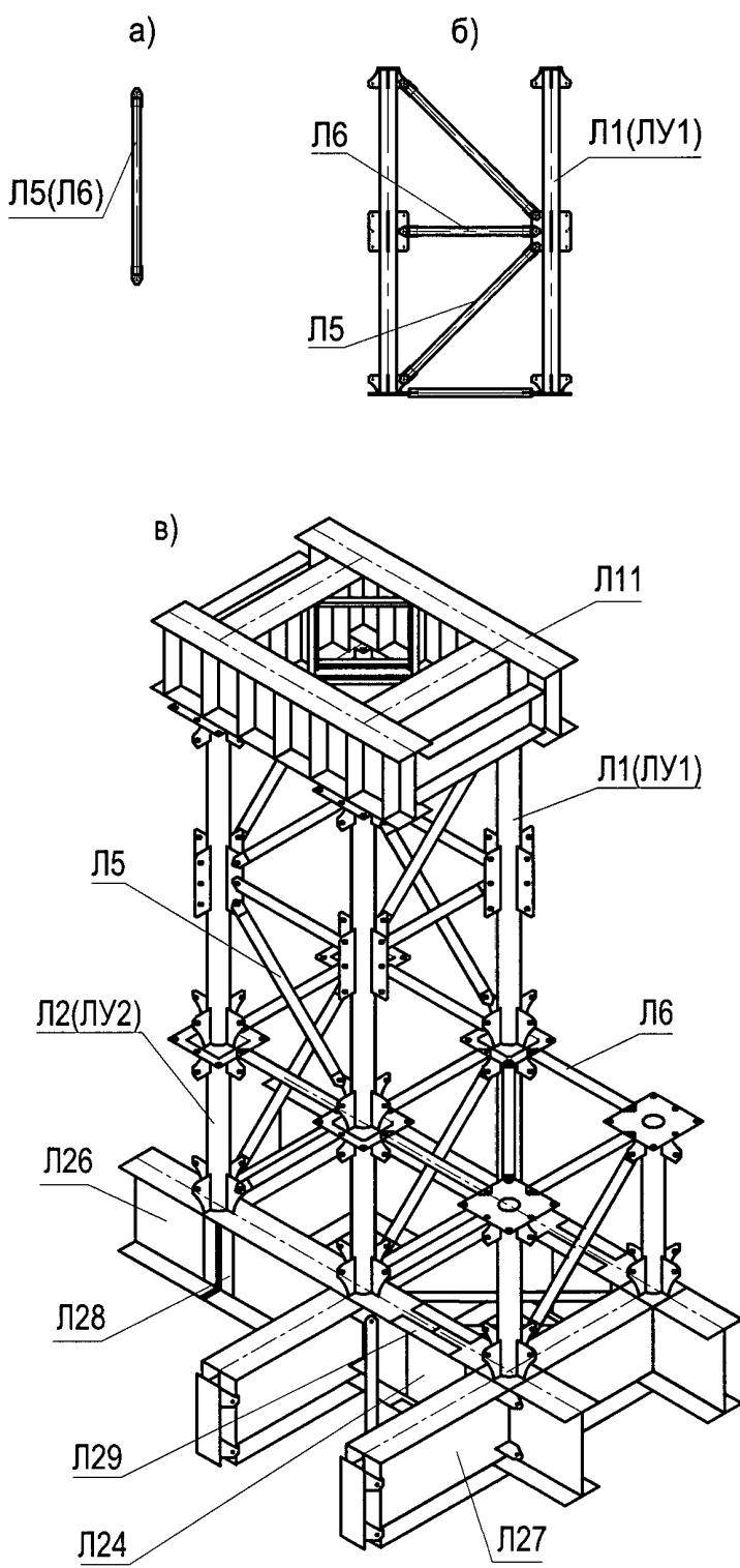
Рисунок 5.1 — Схема сборки опоры из элементов МИК-С2
