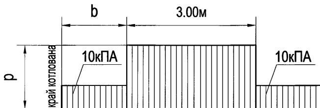
Рисунок 10.1 — Вертикальная нагрузка на призме обрушения от автотранспорта
