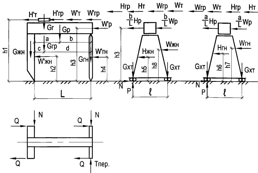
Рисунок 12.2 — Схема приложения нагрузок к козловому крану
