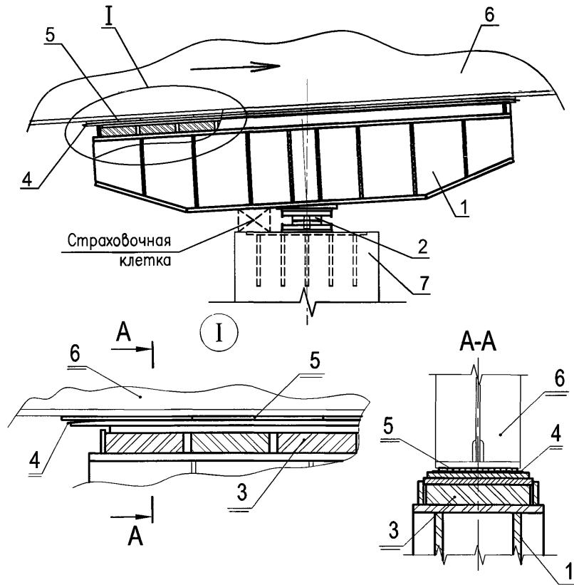
Рисунок 28.1 — Устройства скольжения непрерывного действия.
