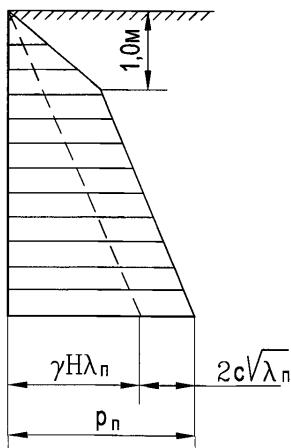
Рисунок 10.11 — Эпюра пассивного давления суглинка
