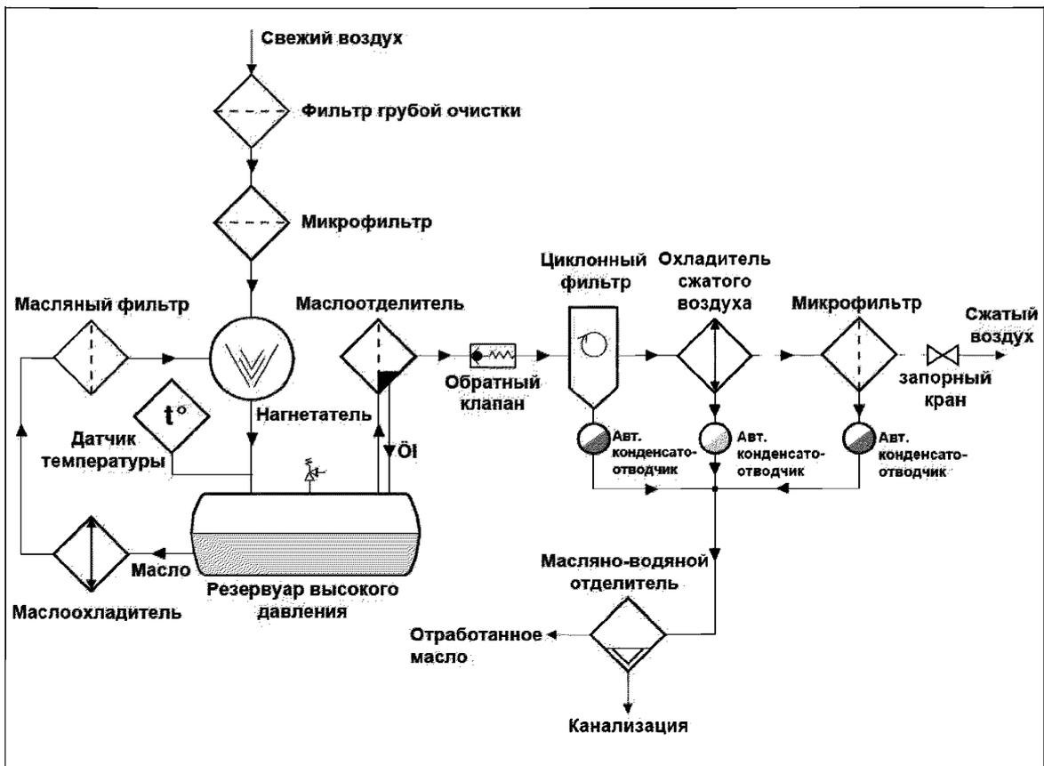
Рис. 1: Схема подготовки и подачи сжатого воздуха (пример)
