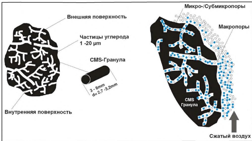
Рис. 4: Адсорбционная технология разделения газов
