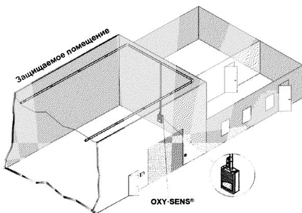
Рис. 10: Размещение прибора OXY·SENS® в защищаемом помещении
