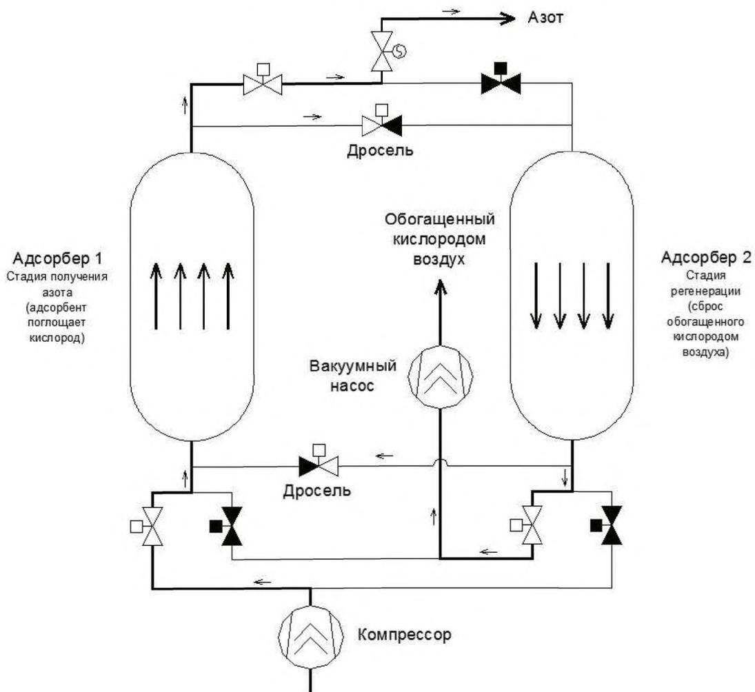
Рис. 5: Схема работы системы OxyReduct® (адсорбционный способ разделения газов)
