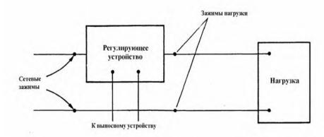
Рисунок 5а - Схема измерений РП для регулирующего устройства с двумя зажимами
