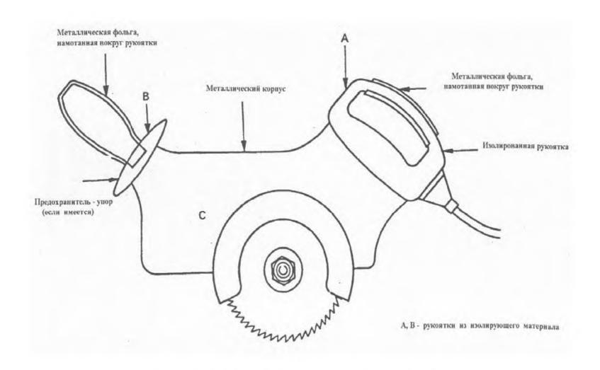
Рисунок 8с – Ручная (портативная) электропила Рисунок 8 – Применение эквивалента руки (см. 5.1.4 и 5.2.2.2)
