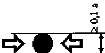
с) символ стрелок на рабочей поверхности, которая содержит виртуальную кнопку для ручного пожарного извещателя типа А
