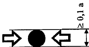
c) Symbol auf dem Bedienfeld für die Pfeile einschließlich eines virtuellen Knopfes für Handfeuermelder vom Typ A
