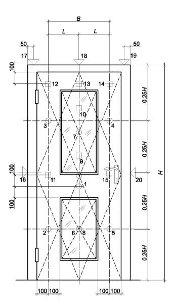
р, ¬, □ — ТЭП для определения максимальной локальной температуры по 9.1.2 (также см. рисунок Б.1);
