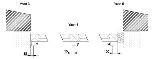
— положение ТЭП при определении роста максимальной температуры по 9.1.2 (также см. рисунок Б.1)
