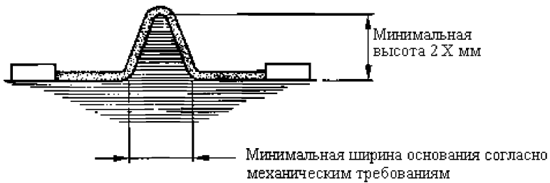
Рисунок А.1 – Измерение высоты рифления изоляции
