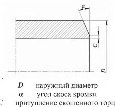
Рисунок 1 — Скос торца трубы
