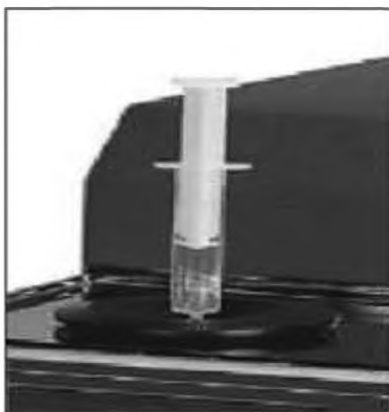
Рисунок 1 - Шприц, введенный во впускное отверстие
