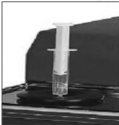
1-сурет – Қосу саңылауына енгізілген шприц
