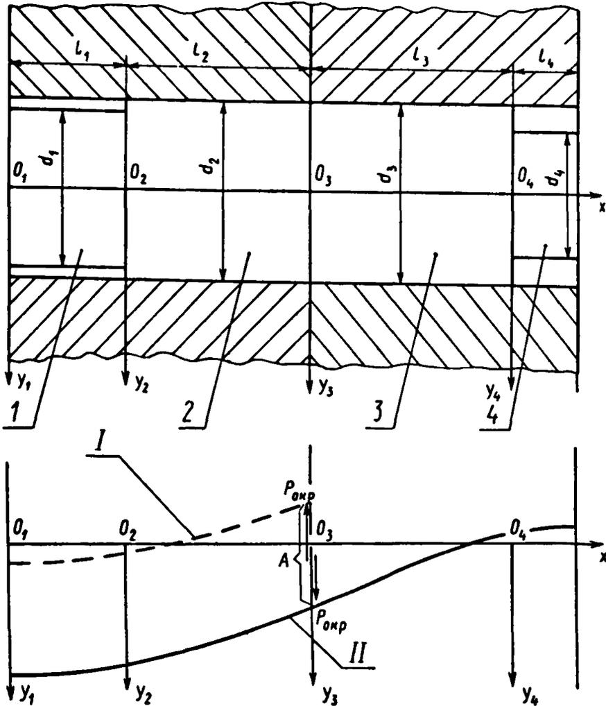
1, 2, 3, 4 — расчетные участки болта; I — расчетное смещение 1-го и 2-го участков болта при смещении левого фланца; II — действительное смещение болта
