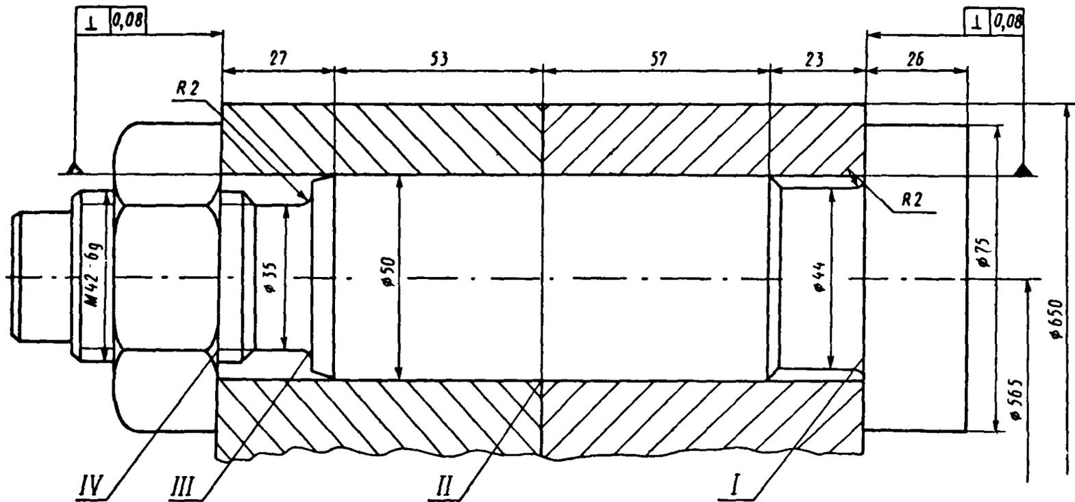
I, II, III, IV — сечения, в которых определяется усталостная прочность болта
