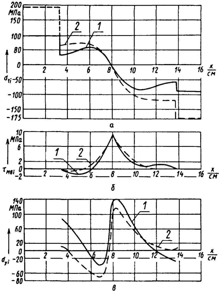
$a$  — напряжения изгиба;  $b$  — напряжения среза;  $v$  — напряжения смятия; 1 — результаты расчета при  $\alpha = \alpha_1 = 0$ ; 2 — результаты расчета при  $\alpha = \alpha_1 = 1 \cdot 10^{-3}$  рад
