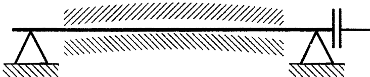
Рис. 9. Схема возникновения задеваний в проточной части из-за коробления цилиндра в горизонтальной плоскости ( \Delta t_{\text{верх-низ}} – выше нормы)
