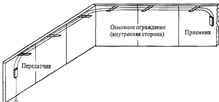
Рисунок 5 - Вариант блокировки "козырька" основного ограждения извещателем "Уран-1М"
