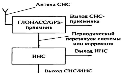
Рисунок 5 - Структурная схема навигационного устройства, совмещающего применение инерциальной и спутниковой систем навигации
