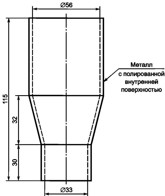
Рисунок 1 — Воронка для определения насыпной плотности
