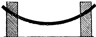
Рис. 3. Схема формования выкладкой заготовки на контурной рамке
