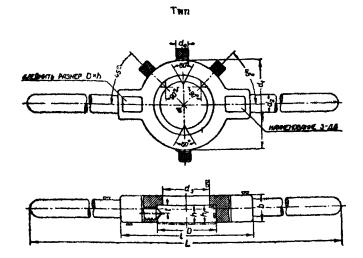
Пример ебозначения воротка для круглых плашек диам. D = 55 мж и шир. h = 22 мм
