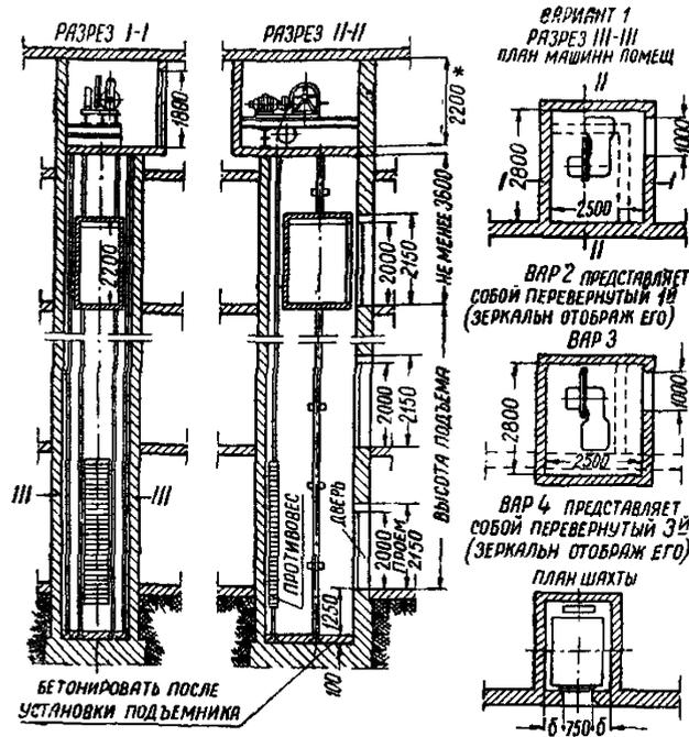
1. Поперечные размеры шахт и простенков *б* см. лист 7. 2. Конструкция механизмов и способ их установки не стандартизуются.
