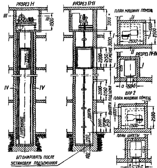
1. Поперечные размеры шахт и простенков *а* и *б* см. лист 7. 2. Конструкция механизмов и способ их установки не стандартизуются.
