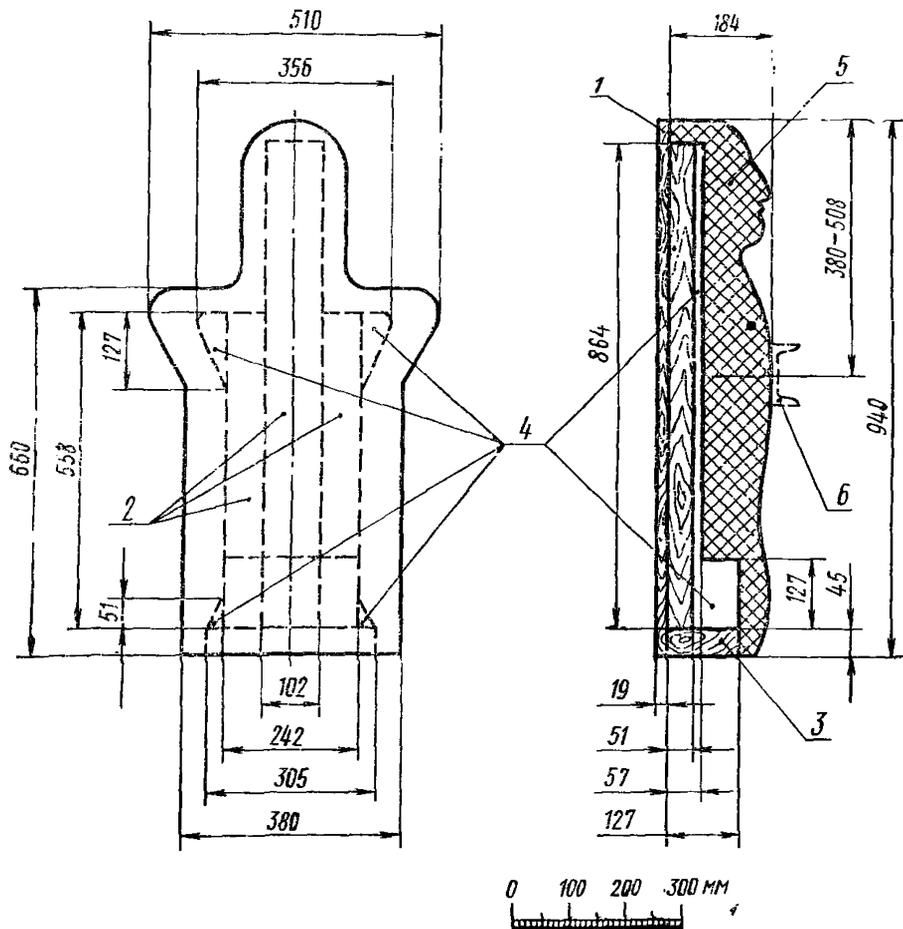
1 — основание из фанеры; 2 — незакрепленные бруски из сосны; 3 — поперечина основания из соснового бруса; 4 — полости в облицовке; 5 — облицовка из резины, прикрепляемая к основанию с помощью ремней или клейкими лентами; 6 — швеллер № 10 по ГОСТ 8240—72 для определения жесткости модели туловища.
