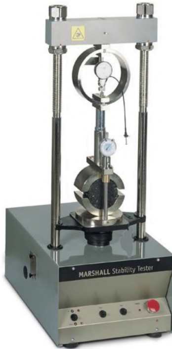
Рисунок 25. Установка с контрольным кольцом и расходомером для проведения испытаний по методологии Маршалла
