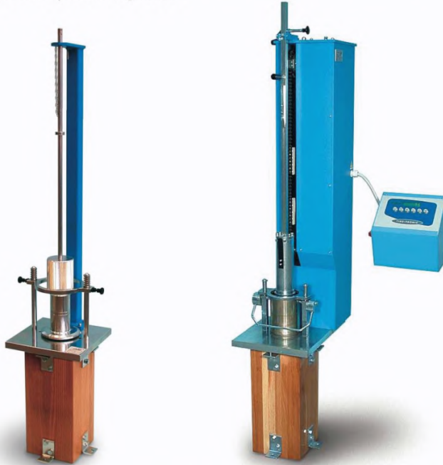
Рисунок 22. Уплотнители Маршалла с ручным молотом и с механическим молотом.
