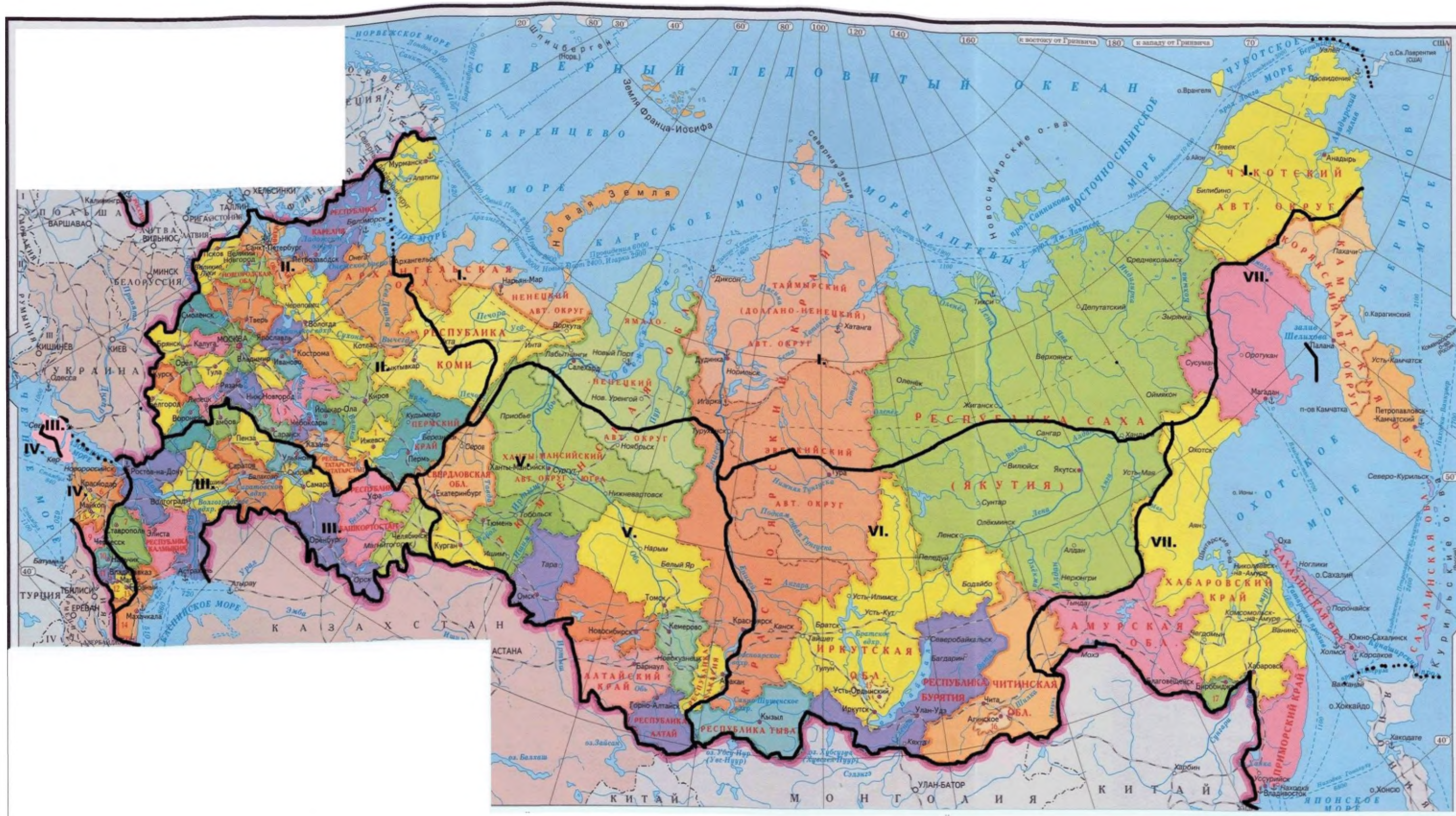
Рисунок 1 – Агрорландшафтное районирование территории России для оптимального подбора видов и сортов трав для укрепления откосов земляного полотна автомобильных дорог
