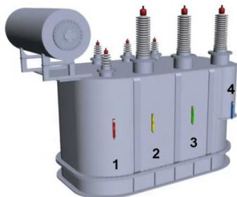
Рисунок Б.5 – Установка датчиков измерений разрядной активности типа ТМР-У на баке трансформатора для проведения объемной локации
