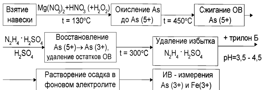
Рисунок 3. Основные этапы анализа проб БАД при определении массовой концентрации мышьяка и железа
