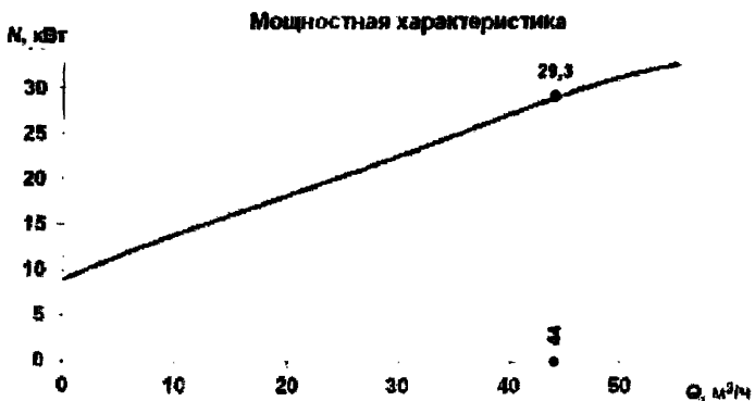
Характеристики при номинальной частоте вращения на воде плотностью 1000 кг/м³ Рисунок Д. 49е Насосный агрегат МСТ-ЦН-Г-01-ДГ-А-44/190-Е-37-УХЛ2
