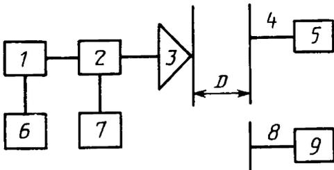
1 — генератор; 2 — индикатор уровня; 3 — излучающая антенна; 4 — образцовая дипольная антенна; 5, 7 — милливольтметр постоянного тока; 6 — частотомер; 8 — поверяемая антенна; 9 — селективный милливольтметр
