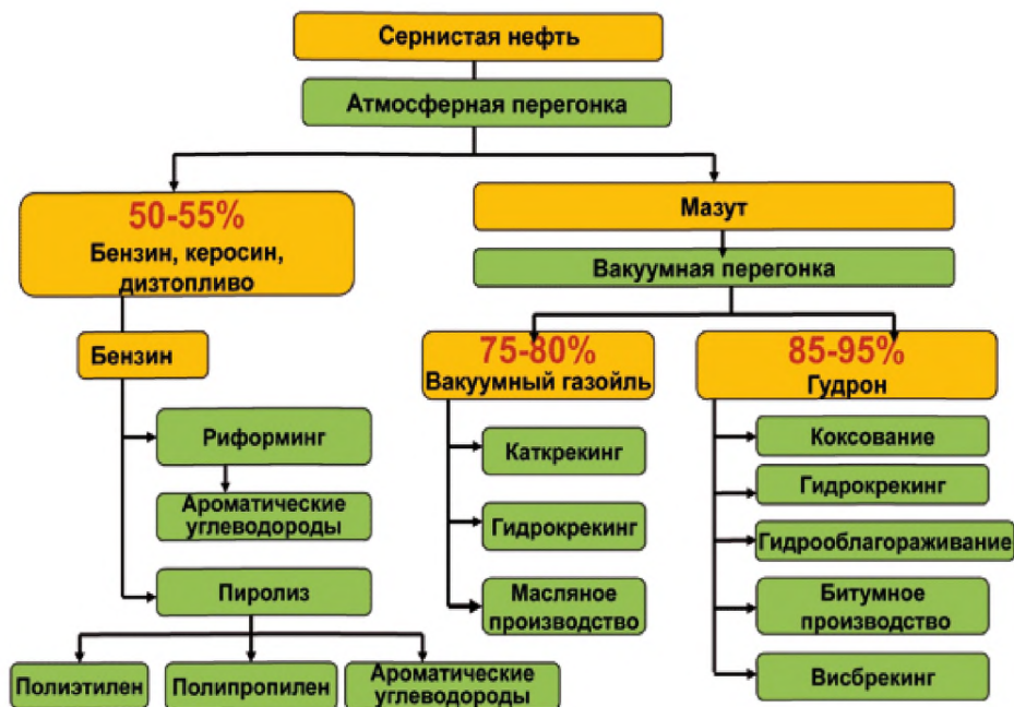
Рисунок 1.14 – Изменение глубины переработки нефти
