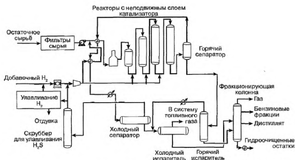
Рисунок 7.11 – Технологическая схема процесса RCD Unionfining
