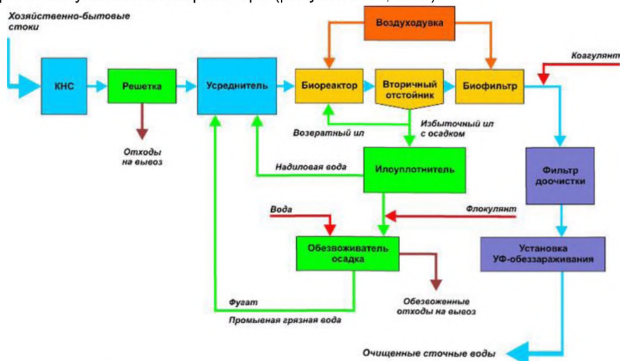
Рисунок 2.96 – Схема биологической очистки сточных вод
