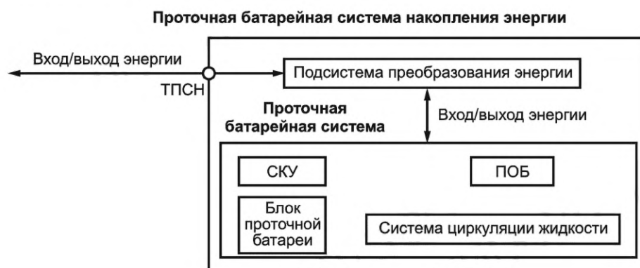
Рисунок 1 — Пример архитектуры СНЭБП
