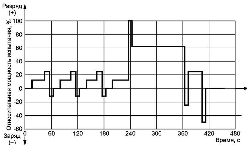
Рисунок 4 — Динамический разрядный профиль В циклирования аккумуляторов для ЭМА
