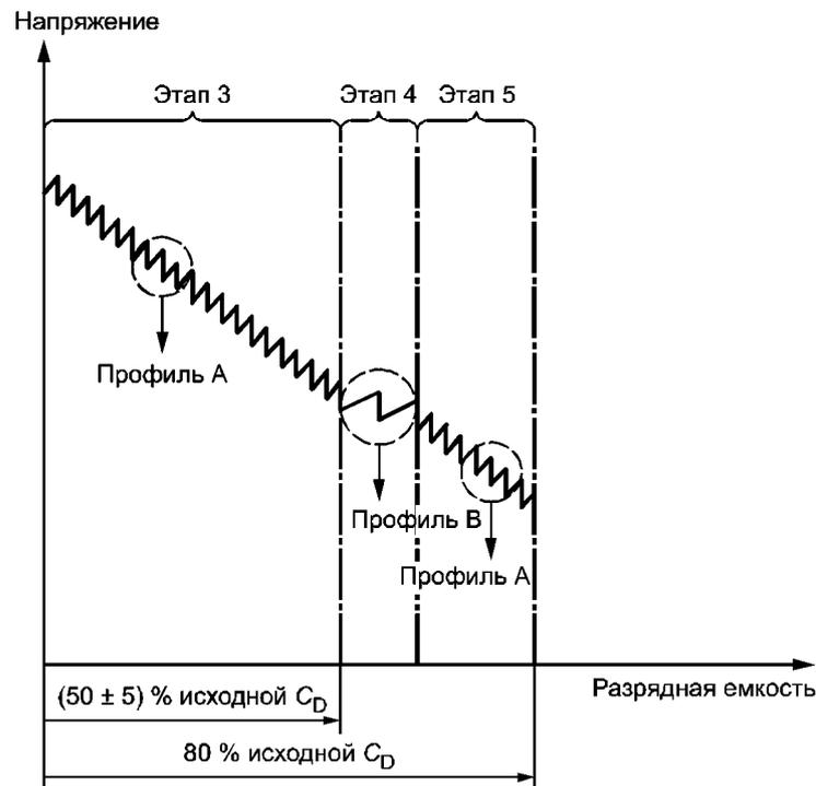
Рисунок В.2 — Концепция циклирования для аккумуляторов ЭМА
