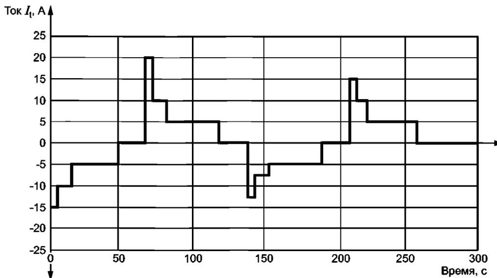
Рисунок 6 — ППЗ при циклировании аккумуляторов для ЭМГ
