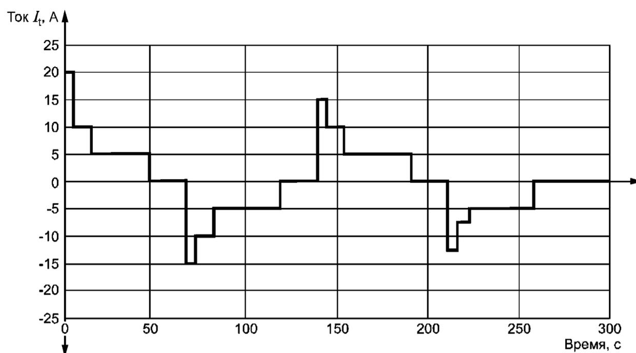
Рисунок 5 — ППР при циклировании аккумуляторов для ЭМГ
