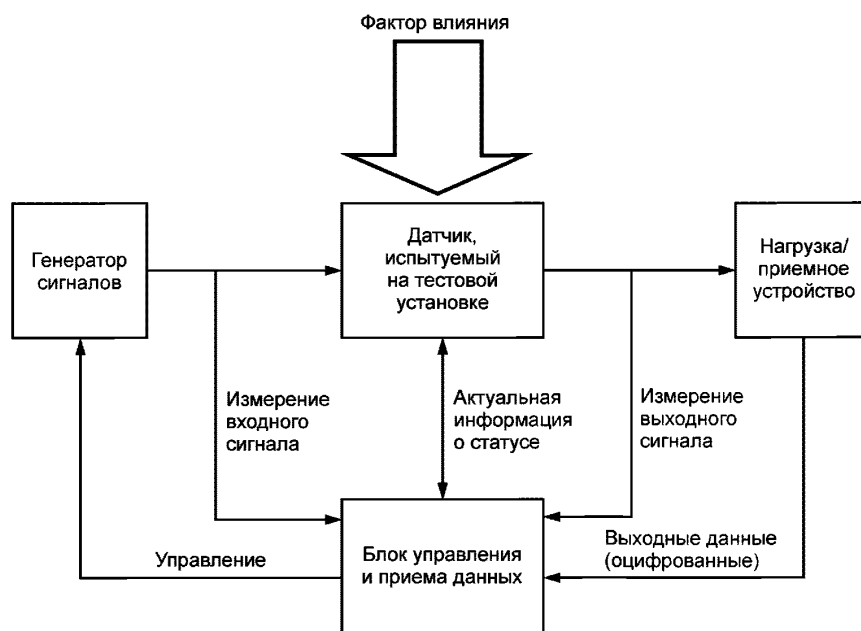
Рисунок 2 — Базисная схема установки для проведения тестовых испытаний
