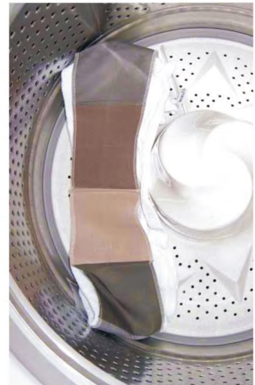
Рисунок Н.11 — Стиральные машины с вертикальной осью: расположение предметов в барабане
