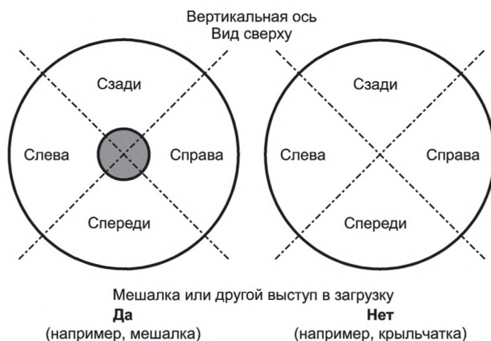
Рисунок Н.14 — Стиральные машины с вертикальной осью, четыре четверти (вид сверху)
