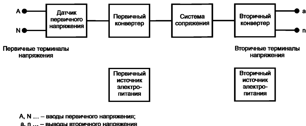
Рисунок 1 — Блок-схема заземляемого однофазного ЭТН
