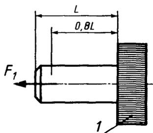
1 — поверхность компонента;  $F_1$  — усилие растяжения
