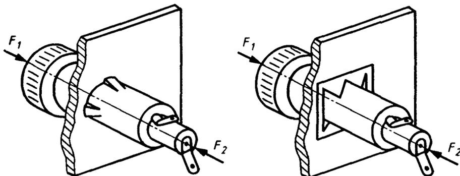
Рисунок 7 — Установка держателей плавких предохранителей на панелях
