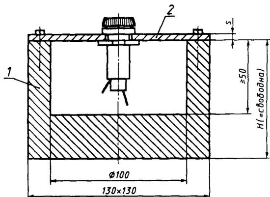
1 — металлическая или бетонная подставка; 2 — металлическая опора
