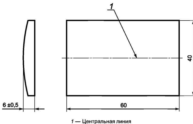
Рисунок 1 — Цилиндрическая линза
