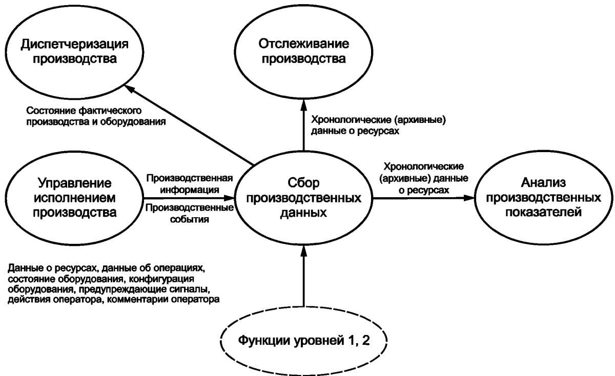
Рисунок А.4 — Интерфейсы функциональной модели сбора производственных данных (МЭК 62264-3)
