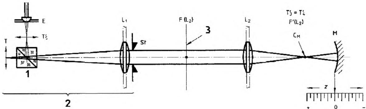
1 – светоделитель; 2 – автоколлимационный телескоп; 3 – опорная плоскость фороптора;  $F$  – фокус;  $M$  – вогнутое зеркало;  $C_M$  – центр кривизны зеркала;  $E$  – окуляр;  $L_1$ ,  $L_2$  – объективы;  $St$  – диафрагма;  $T$  – объект;  $T'$  – изображение объекта
