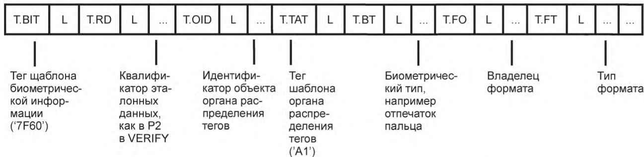
Рисунок В.2 — Пример шаблона биометрической информации (BIT), тегов, назначенных специальным органом распределения тегов
