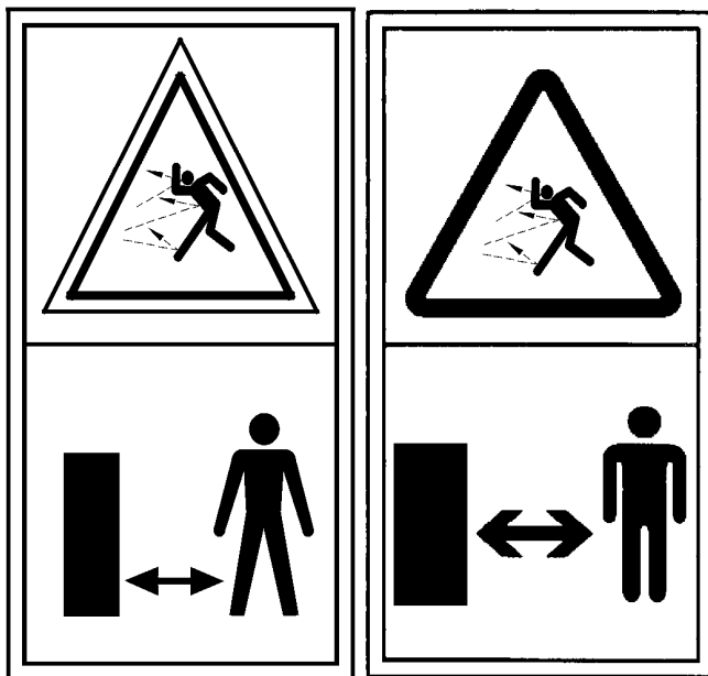
Рисунок ЕЕ.4 — Знак безопасности, обозначающий: «ПРЕДУПРЕЖДЕНИЕ — Держитесь на безопасном расстоянии от работающей машины»
