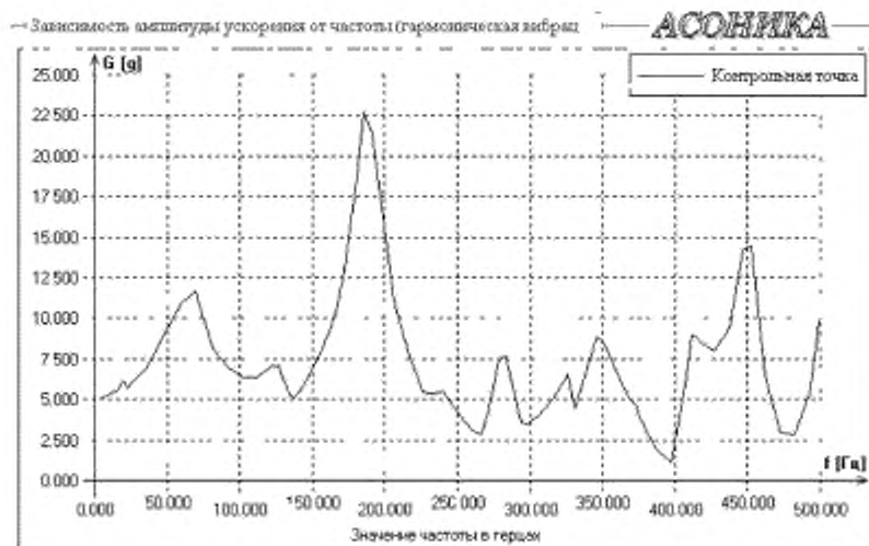
Рисунок Б.9 — Зависимость амплитуды ускорения гармонической вибрации от частоты в контрольной точке (в центре платы)
