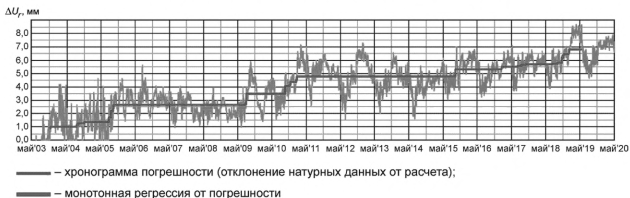
Рисунок Г.2 — Отклонение натуральных данных от расчетных в радиальных перемещениях гребня центральной секции бетонной арочно-гравитационной плотины, мм
