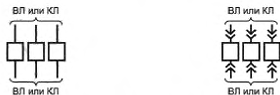
а) Схема для распределительных пунктов со стационарным расположением выключателя (в том числе мачтовых)
