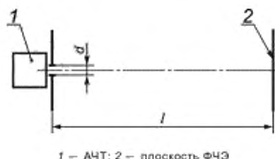
Рисунок Д.1 — Схема формирования потока излучения, создаваемого высокотемпературным АЧТ
