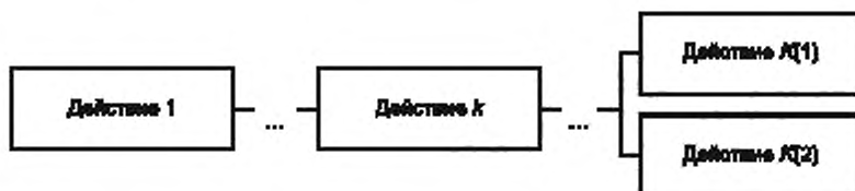
Рисунок Г.2 — Пример моделируемой системы, представляющей собой множество действий процесса. Системный элемент — конкретное действие (последнее K -е действие задублировано)
